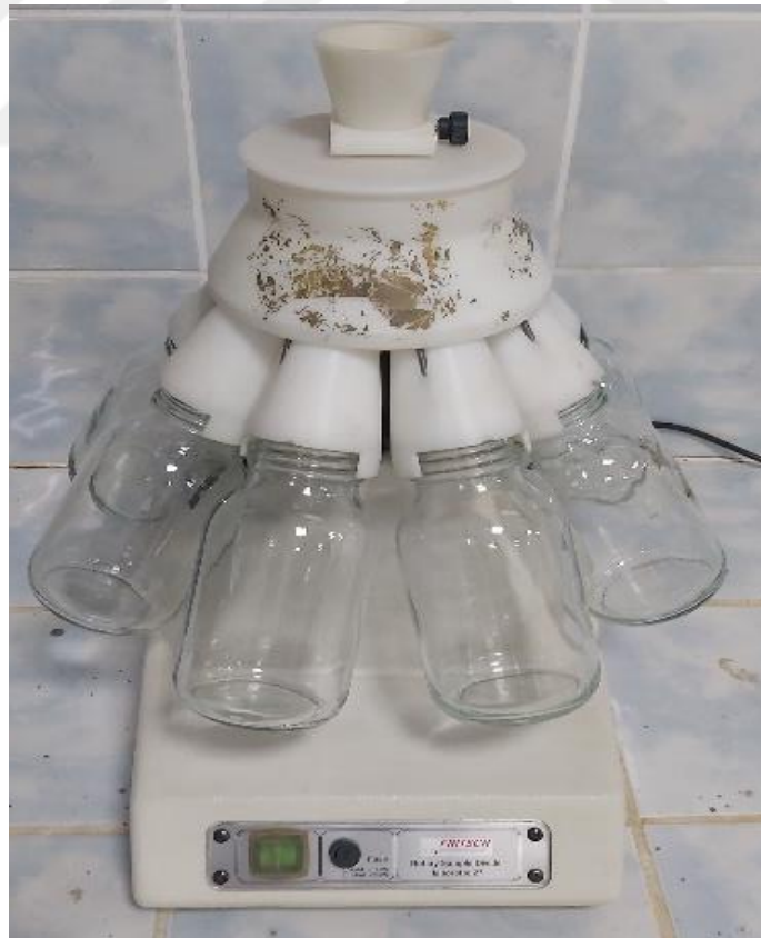
Şekil 3.2. Otomatik döner koni numune bölücü (Haver RPT)
