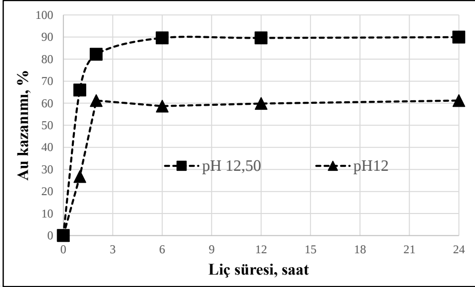
Şekil 4.27. pH'nin (12,5) altın çözünmesine etkisi (Glisin:1 M; T: 60°C; hava: 2 L/dk; katı oranı: %20; 600 dev/dk E_h < -101 mV).
