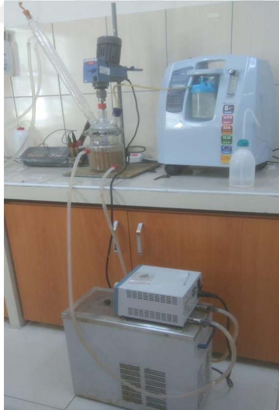
Şekil 3.4. Glisin liç testinde kullanılan deneysel kurulum
