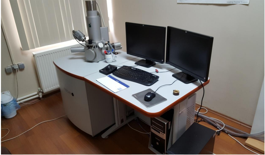
Şekil 2.6. Taramalı elektron mikroskobu (SEM)
