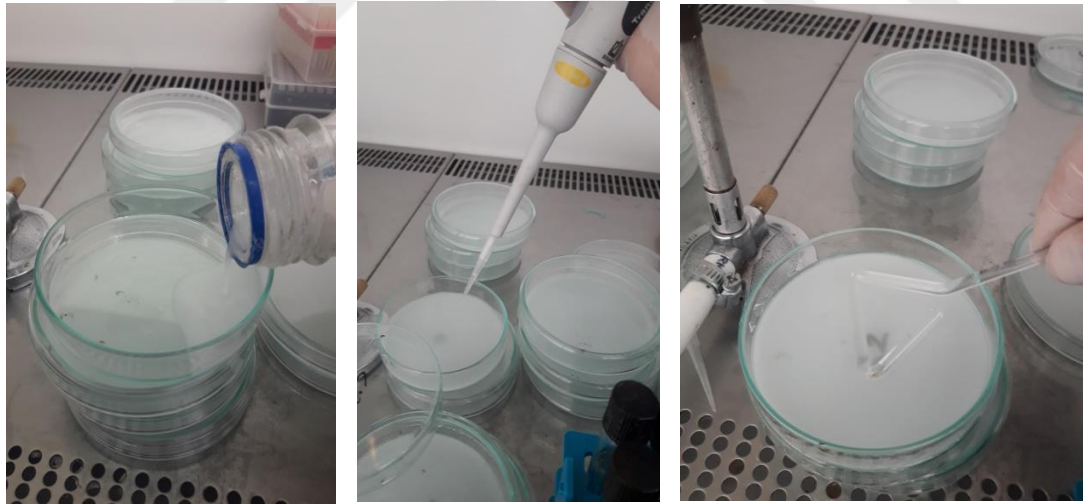
Resim 3.3. Fosfor çözen bakterilerin belirlenmesi için dilüsyon örneklerinden ekim işleminin yapılması
