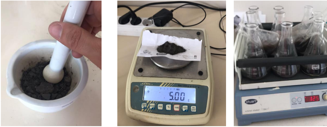
Resim 3.2. Rizosfer toprak örneklerinin bakteri izolasyonuna hazırlanması
