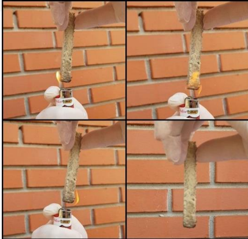
Görsel 6.2. Alev geciktirici katkı maddeleriyle kaplanmış ısı yalıtım malzemesinin yanma testi sırasındaki görüntüleri
