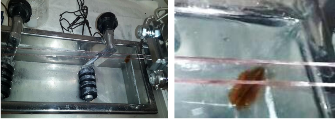
Görsel 5.1. Ekstrüderden eriyik halinde çekilen bir karışım örneği
