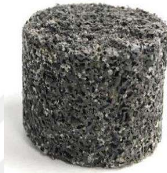
Görsel 5.5. Atık/Ham LDPE (90/10) ısı yalıtım malzemesi
