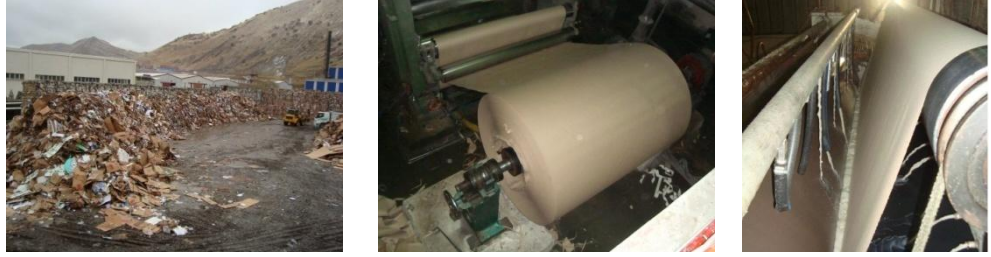
Şekil 6.2. Kağıt-karton geri dönüşüm aşamaları (URL-5)
