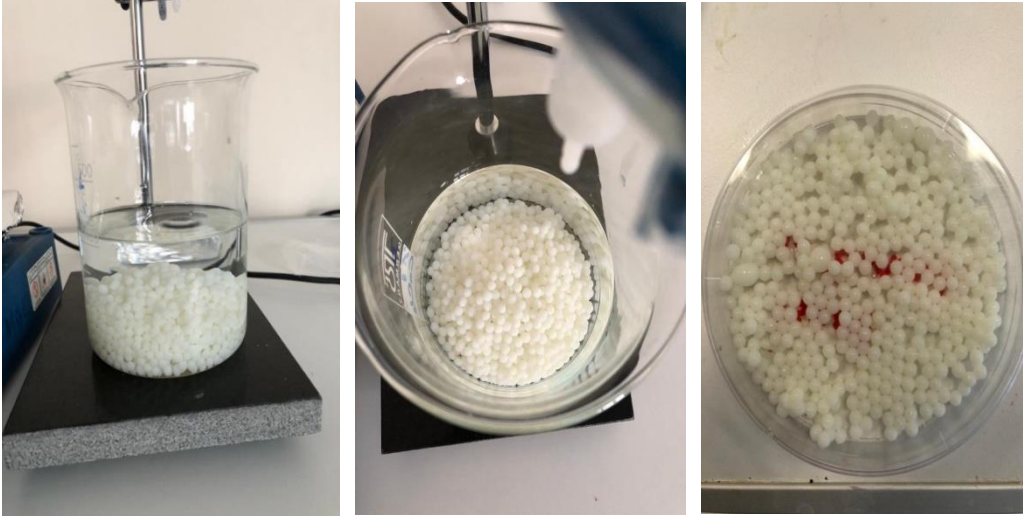
Resim 2.4. Aljinat ile enkapsule edilmiş ZnO-Np (Orijinal)
