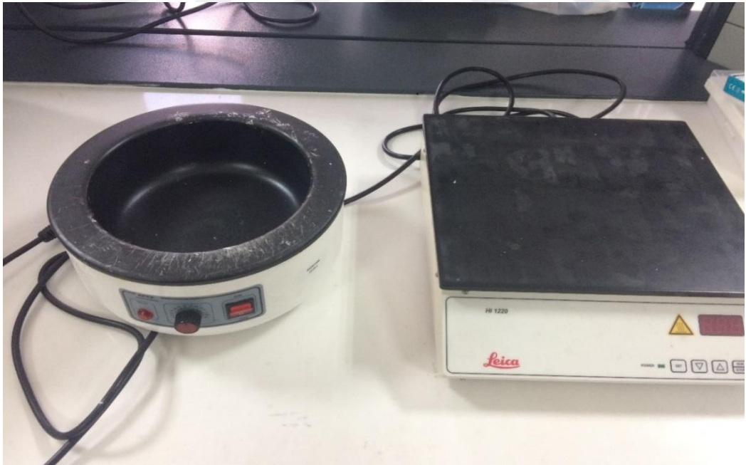
Şekil 3.6. Sıcak su banyosu ve ısıtıcı tabla.
