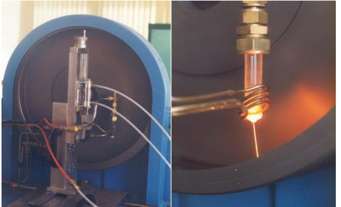
Şekil 2.5. In-rotating water-spinning yönteminin gösterimi [16]
