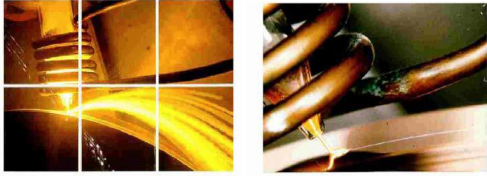
Şekil 2.2. Melt spinning metodu ile amorf şerit ve tellerin üretimi [7]
