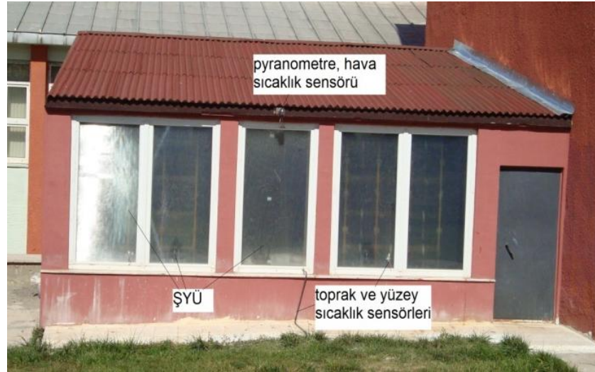
Şekil 3.11. ŞYÜ'nin montajı ve deney odasının son hali
