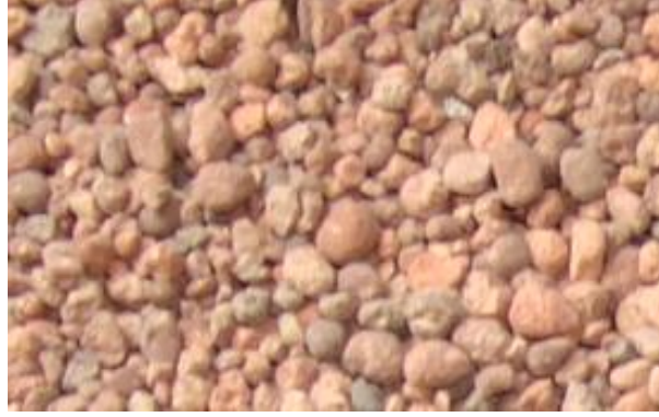
Şekil 3.14. Rubitherm granulate (makrokapsüllenmiş FDM)
