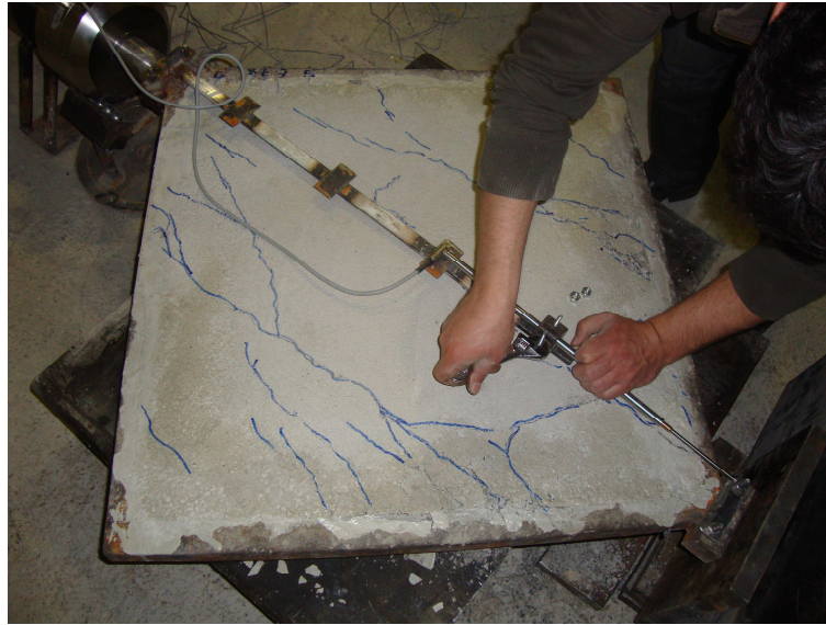
Şekil 4.63. Sekizinci deneysel çalışmaya ait hasar seviyesi
