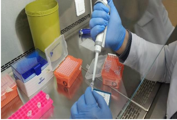
Resim 3.18 PCR reaksiyonlarının hazırlanması, 96 well plate yüklenmesi ve cihaza konulması.
