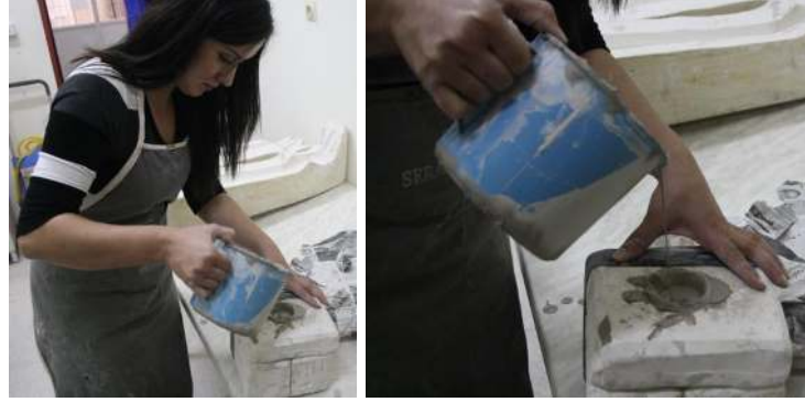
Resim 55: Döküm Yoluyla Şekillendirme Yöntemi
