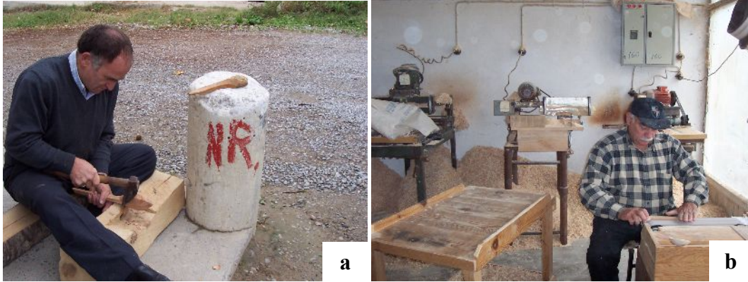
Resim 2.2. Anadolu şimşiri odunundan a : Elde b : Atölye ortamında kaşık yapımı
