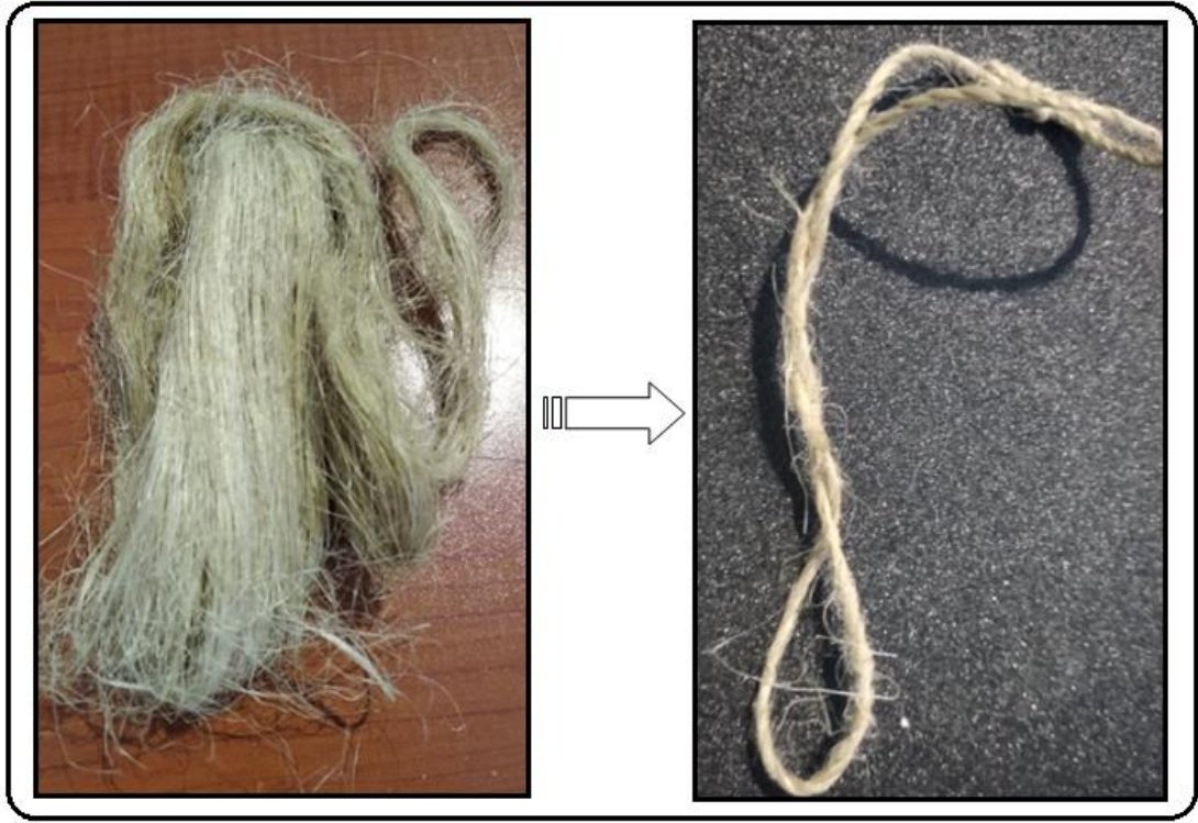
Resim 24: Kenevir lifinin ip haline getirilmesi
