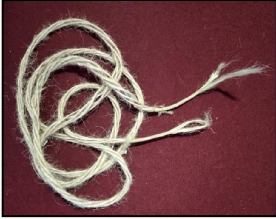
Resim 25: Yay çekiliř denemesinde kopan kiriř ipi
