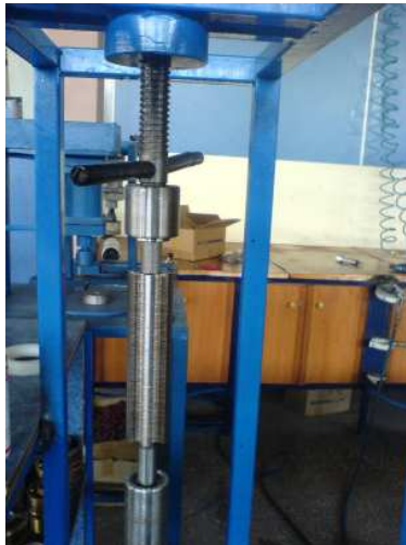
Ek Şekil 8. Rotor saclarının sıkıştırılması
