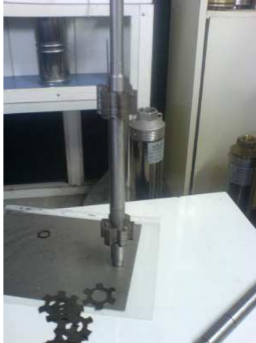
Ek Şekil 7. Rotor saclarının mile yerleştirilmesi
