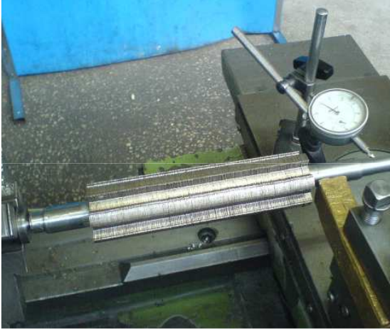
Ek Şekil 9. Rotorun balans ve hava aralığı ayarı
