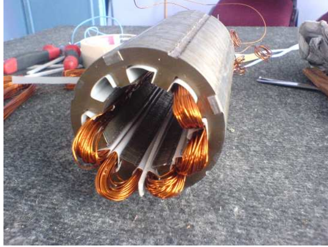
Ek Şekil 4. Stator sargılarının yerleştirilmesi
