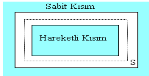
Şekil 4.7 Maxwell Stress Tensor Yönteminde kapalı bir çizginin seçilmesi.
