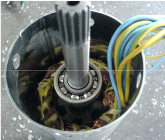
Ek Şekil 8. 8/6 dalgıç pompa tipi ARM'nin toplanması
