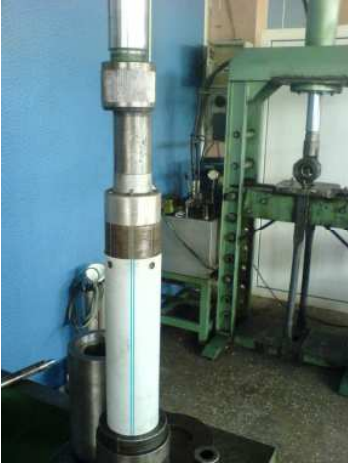
Ek Şekil 9. Rotorun balans ve hava aralığı ayarı
