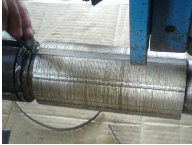
Ek Şekil 2. Stator saclarının sıkıştırılması ve birleştirilmesi
