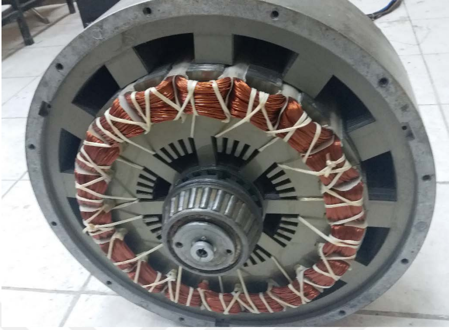
Resim 2.14. 18/12 kutuplu üç fazlı ters ARM
