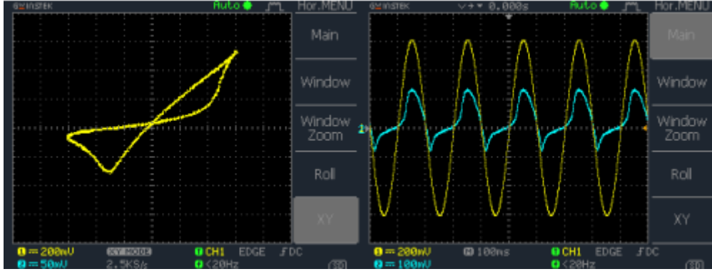
Şekil.3.6. Frekans değeri 5Hz ve 1.2V gerilim uygulandığı histerisiz eğrisi ve akım-gerilim eğrisi [29]
