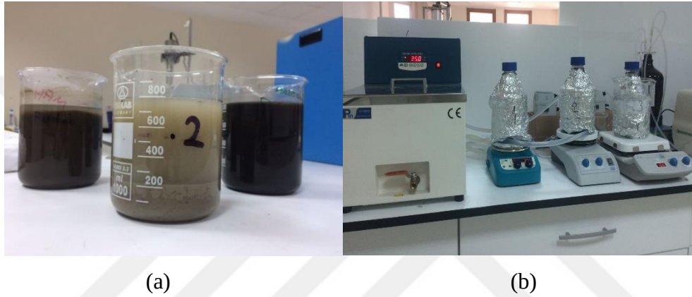
Şekil 3.3. (a) Aklımasyon çalışmalarında kullanılan aşı çamurları (b) aklımasyon reaktörleri
