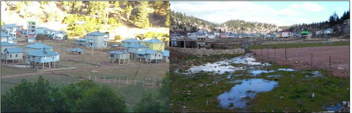
Foto 77. Abanoz Polyesi tabanında inşa edilen konutlar. Zeminde oluşan su birikintileri ve nemden korunmak amacıyla beton direkler üzerine inşa edilmiştir.
