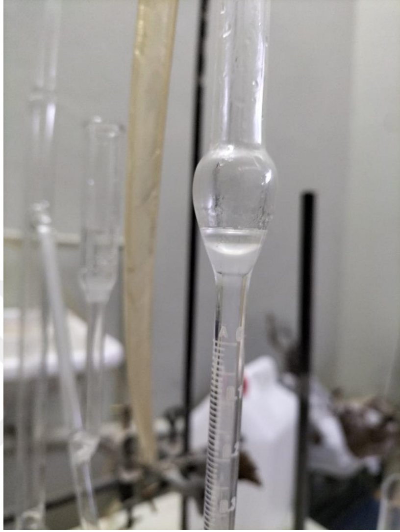
Şekil 3.11 Neo-clevenger cihazı ile anasonda uçucu yağ çıkarma
