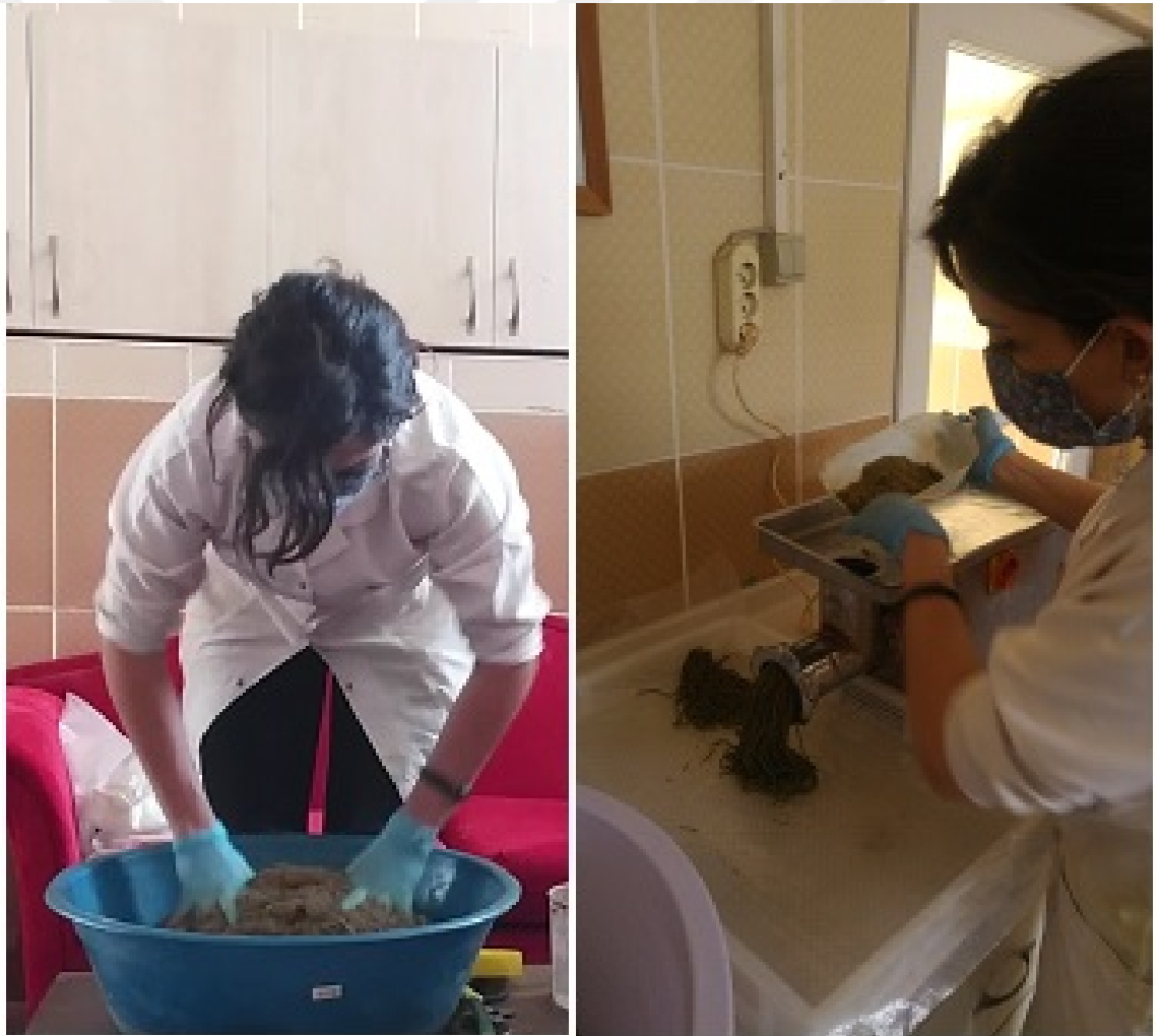
Şekil 3.6. Hammaddelerin su eklenerek hamur kıvamına getirilmesi ve kıyma makinesi ile pelet haline getirilmesi
