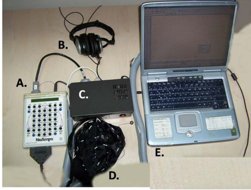
Şekil 1: Operasyon esnasında EEG çekiminde kullanılan cihaz ve ekipmanlar. A. Nuamps (Neuroscan) 40 kanallı EEG amfisi B) Gürültü kesme özellikli kulaklık (Creative HN 700) C) Embedded Interactive Stimulation Unit (EMISU, DEU-BYF) D) 40 Kanal EEG-CAP (Quick cap) E) EEG kayıt bilgisayarı
