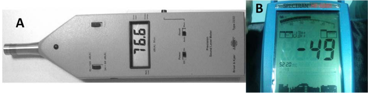
Şekil 15. Şekilde Brüel&Kjær 2232 cihazı (A), Spectran (NF-5020) cihazı (B) görülmektedir. Cihazların ekranlarında örnek ölçüm değerleri bulunmaktadır.
