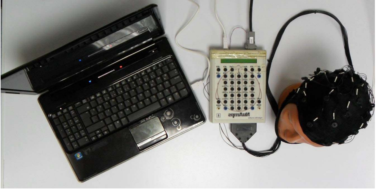
Şekil 3. EEG bonesinin, dijital EEG anfisine ve anfinin de bilgisayara bağlantı düzeneği görülmektedir.
