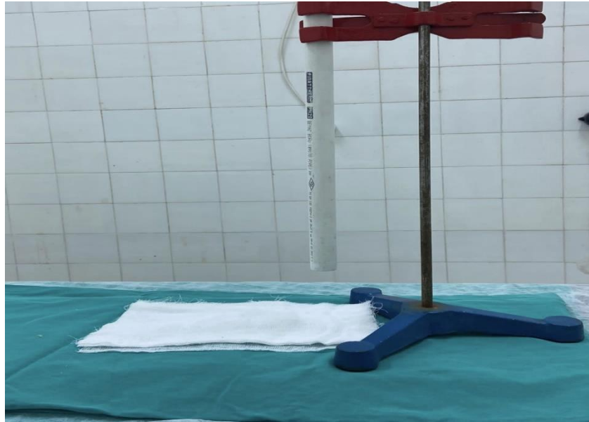
Resim 1: Travmatik beyin hasarı uygulanacak düzenek
