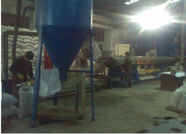
Resim 4.2. Plastik geri dönüşüm tesisinde plastik malzemelerden plastik granül elde edilmesi.
