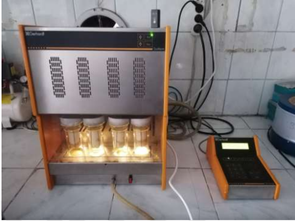
Fotoğraf 2.19. Soxhlet Ekstraksiyon Cihazı ile Yağ Elde Etme İşlemi
