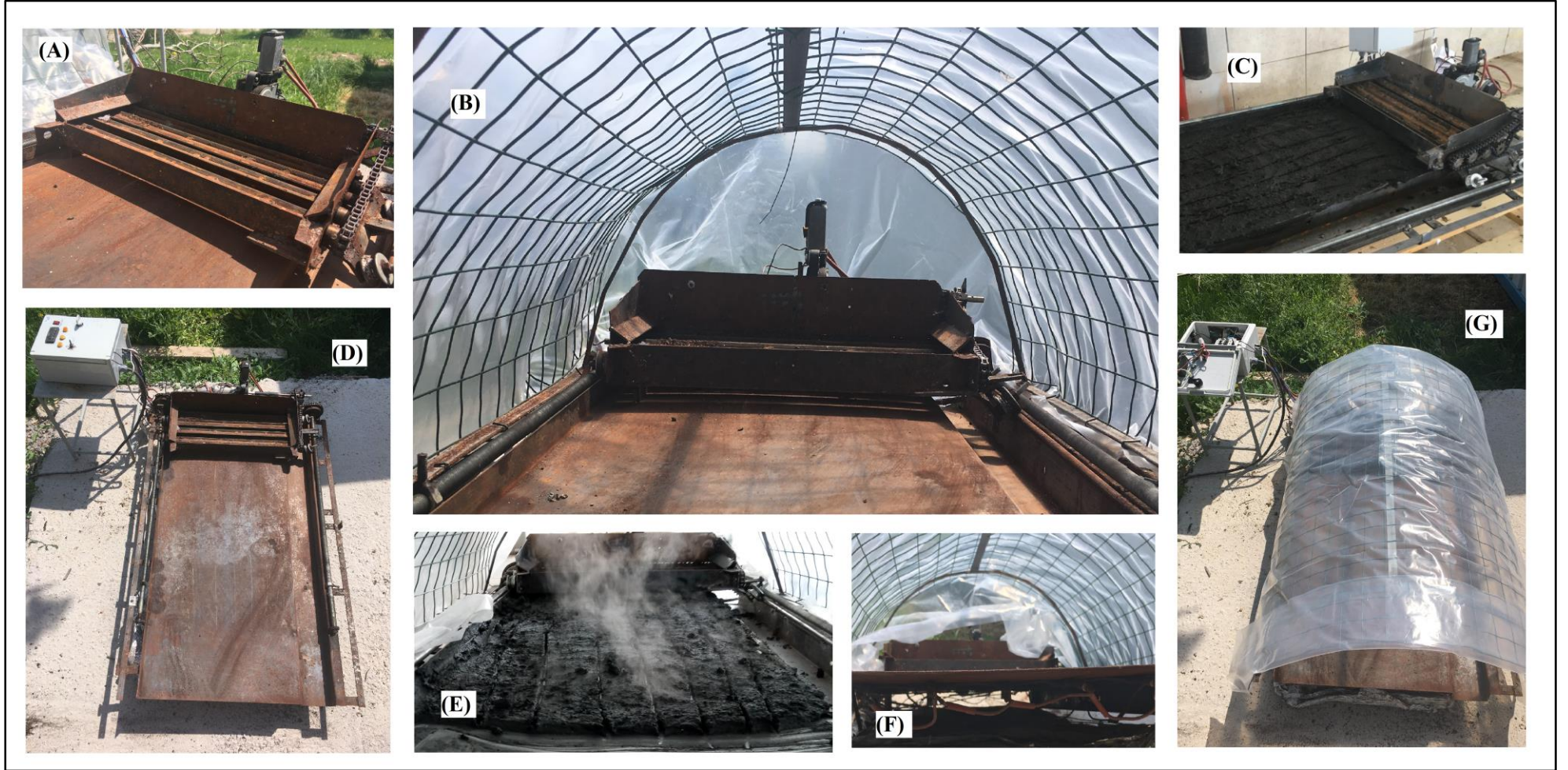
Şekil 3.9: Pilot ölçekli hibrit çamur kurutma sistemi.
