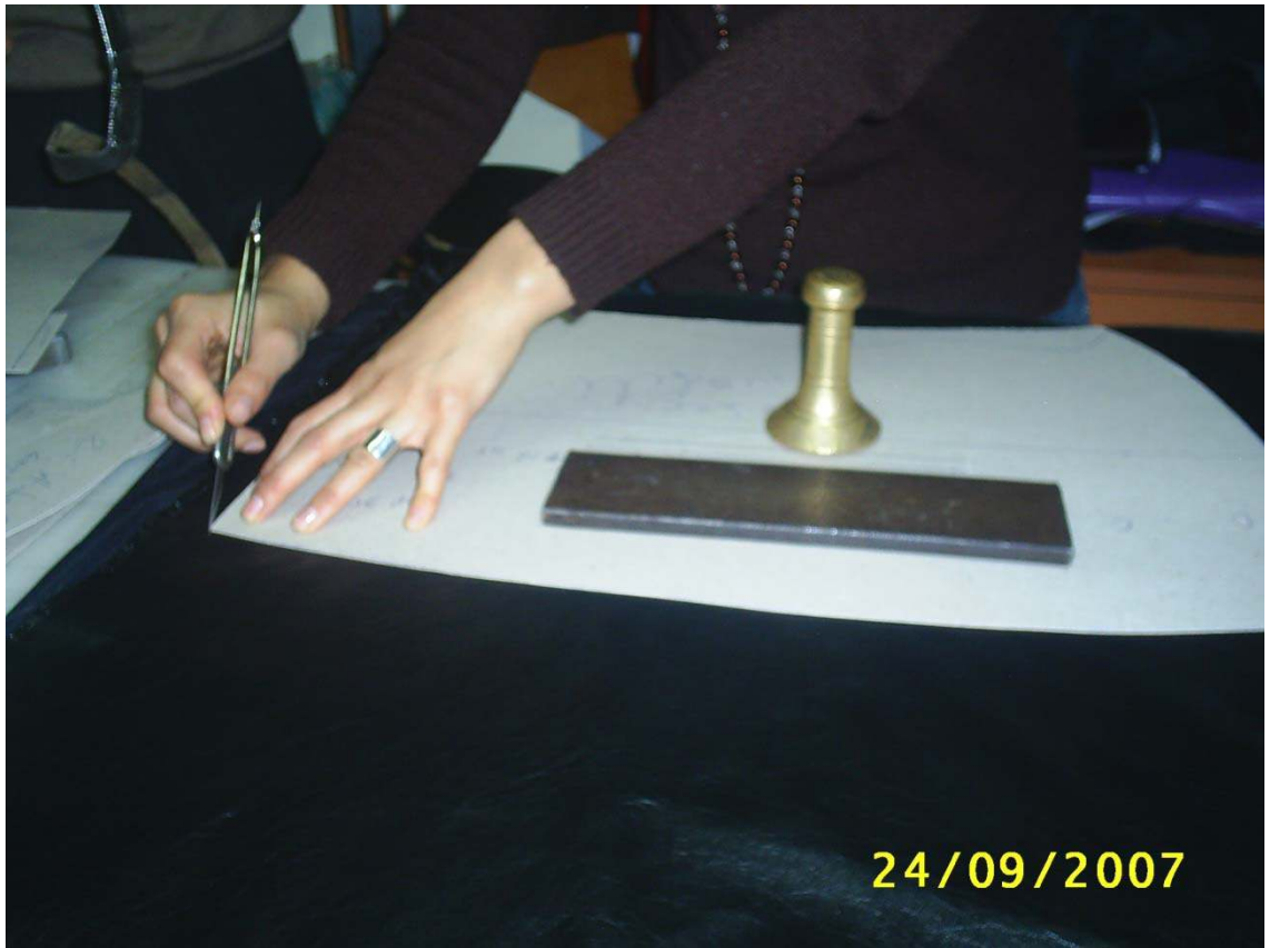
Şekil No: 46 Kalıbı Deriye Uygulama ve Kesme
