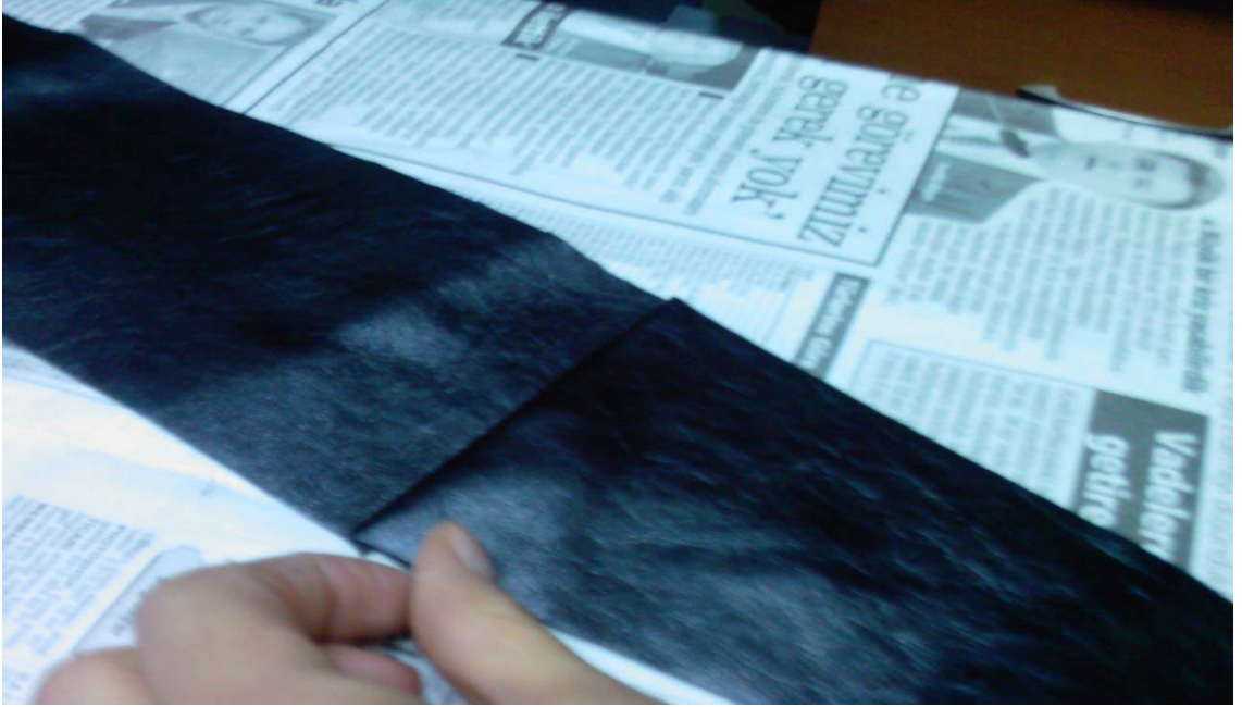
Şekil No: 49 Körük Kısımını Birleştirme
