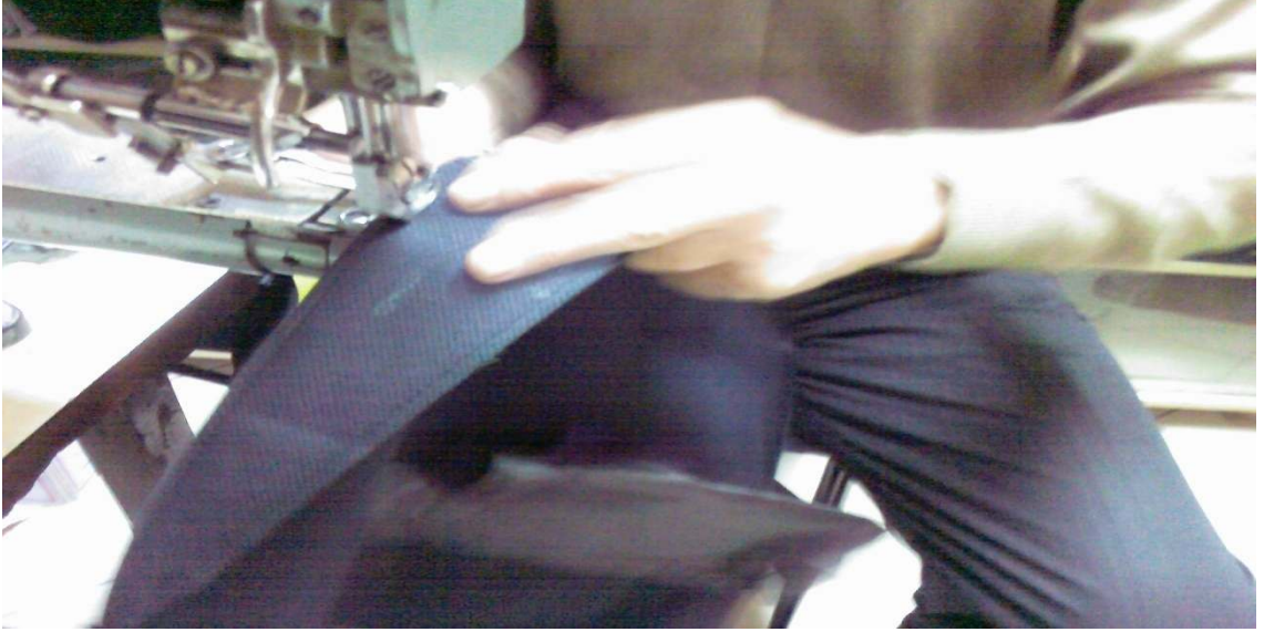
Şekil No: 57 Astarı çantaya birleştirme
