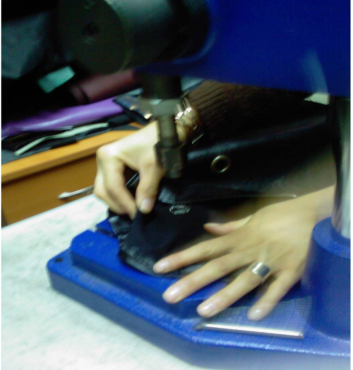
Şekil No: 59 Çantanın büzgü kısmını hazırlama
