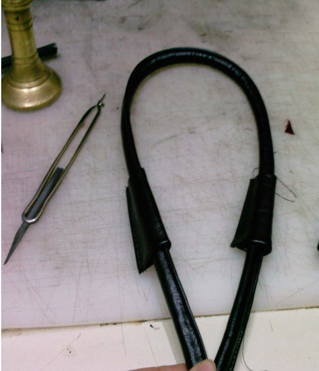
Şekil No: 63 Sapa takılan parçaların hazırlanması
