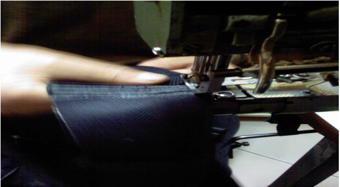
Şekil No: 50 Körük Kısımını Makinede Dikme
