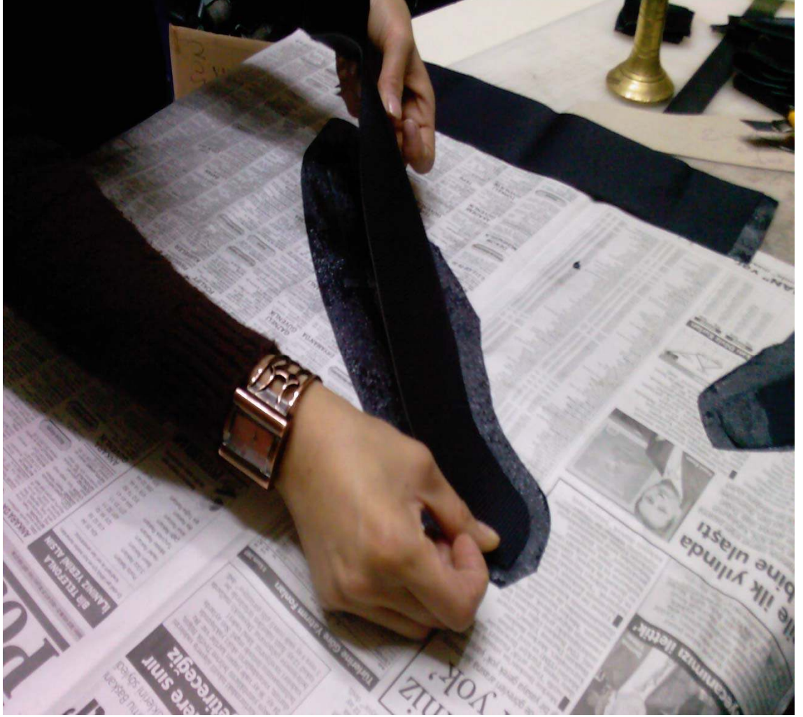
Şekil No: 48 Kesilen Deriyi Sertleştirme
