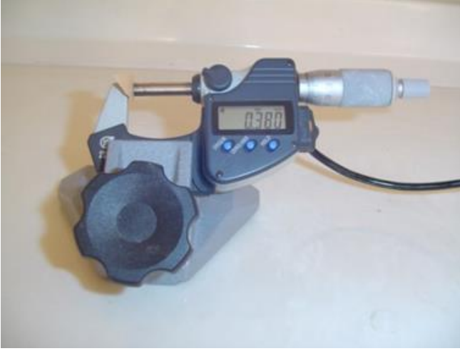
Şekil 3.4. Kabuk kalınlığı ölçüm cihazı
