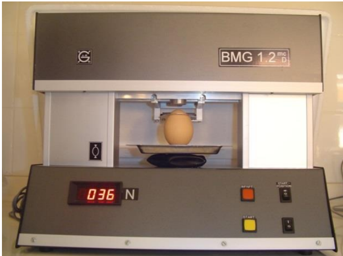
Şekil 3.8. Kabuk kırılma direnci ölçüm cihazı
