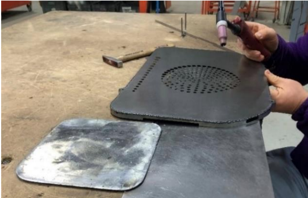
Resim 3.1. Punta kaynak prosesi görseli
