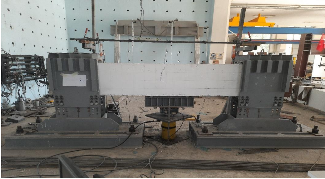
Şekil 35. BK-Ç40 kirişinin deney öncesi hali
