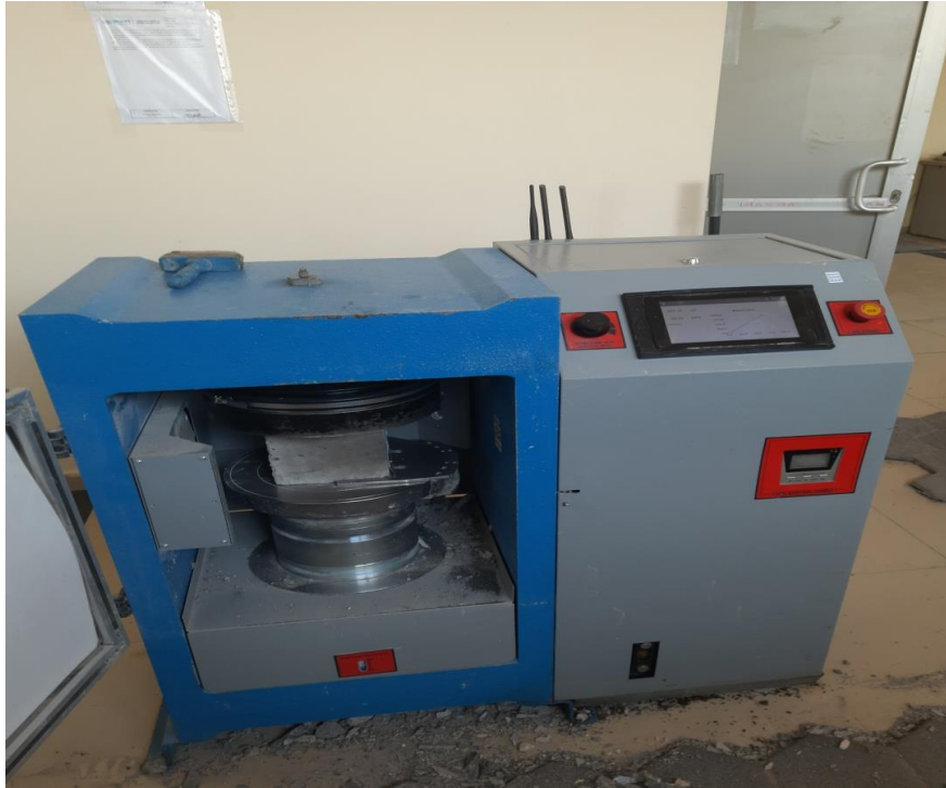
řekil 9. Kp numunelerin basın deneyi
