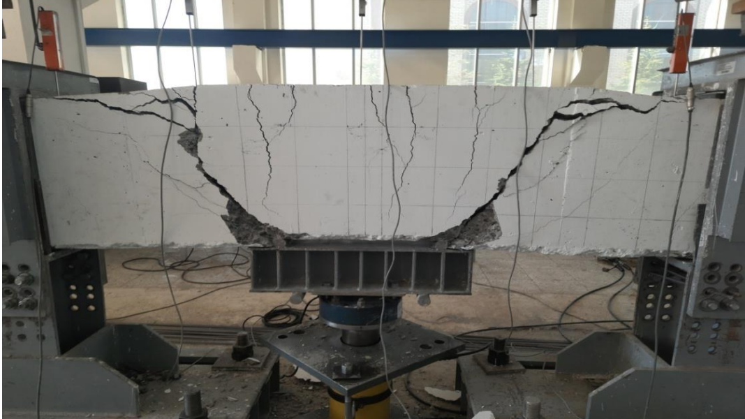
Şekil 28. BK-REF kirişinin çatlak dağılımı ve hasar oluşumu
