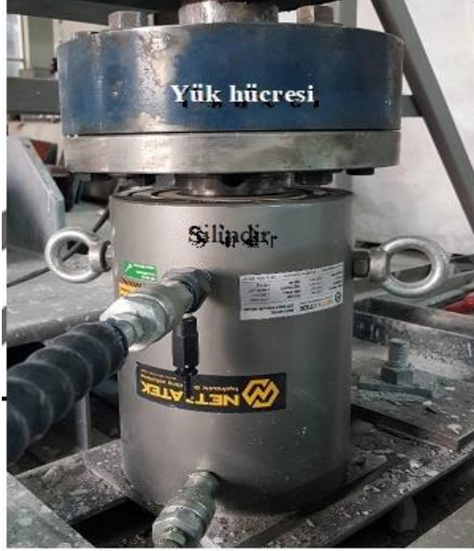
Şekil 18. Yük hücresi ve Hidrolik silindir görünümü
