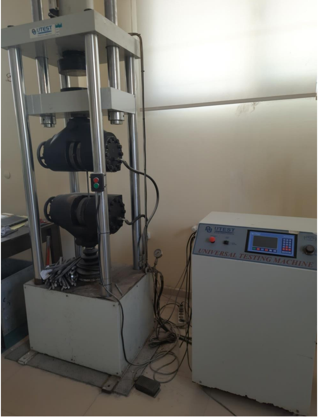
Şekil 10. Çelik çekme deneyi
