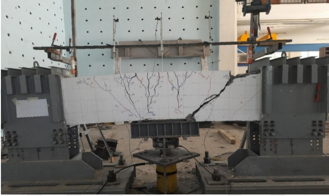
Şekil 37. BK-Ç40 kirişinin maksimum yükteki oluşan çatlak dağılımı
