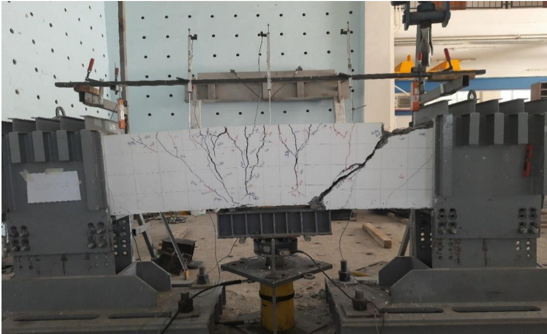
Şekil 38. BK-Ç40 kirişinin deney sonundaki çatlak dağılımı
