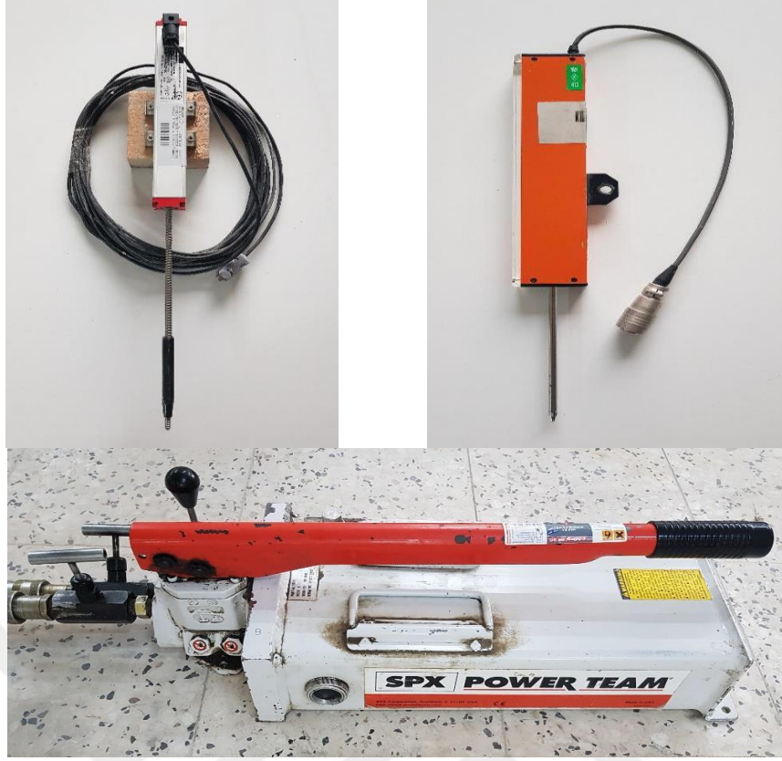
Şekil 22. Deney esnasında kullandığım deplasman ölçerler, hidrolik pompa ve yükleyici krikö
