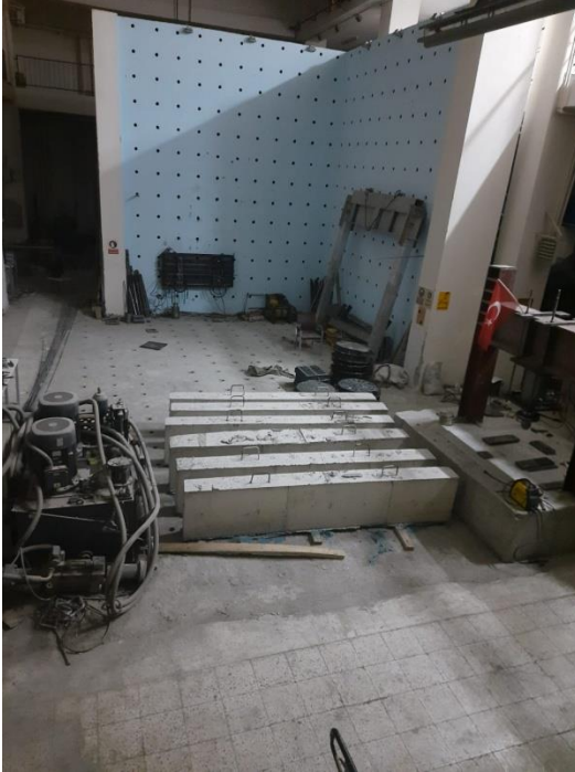
Şekil 15. Kirişlerin laboratuvar içersine taşınıp ve boyanması
