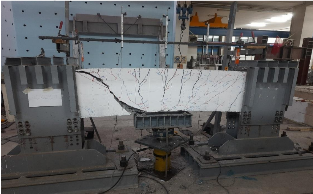
Şekil 48. BK-Ç10 kirişinin maksimum yükteki oluşan çatlak dağılımı
