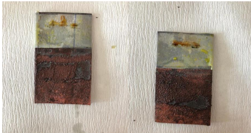
Şekil 4.40. HCl ilavesi ile yapılan sementasyon deneyinden sonra kurşun levhaların yüzeyleri
