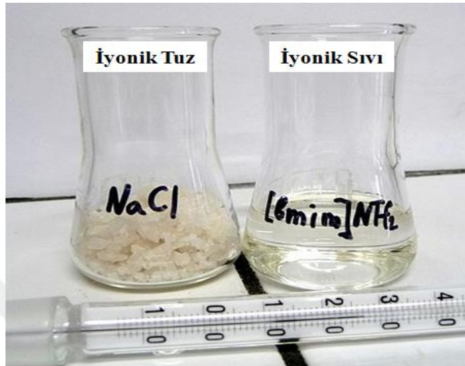
Şekil 2.4. Oda sıcaklığında NaCl ve 1-bütıl-3-metılımdazolyum bıs(trıflorometıl-sülfonıl)ımd bılęıklerının fiziksel durumları (Wikiwand)
