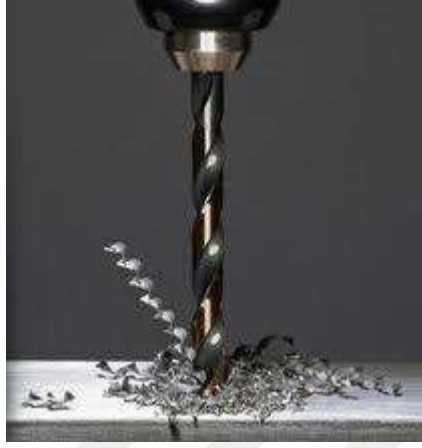
Şekil 3.6. Matkapla delme işlemi
