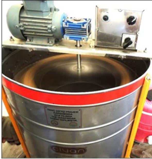
Şekil 1. 12 Bal süzme makinesi
