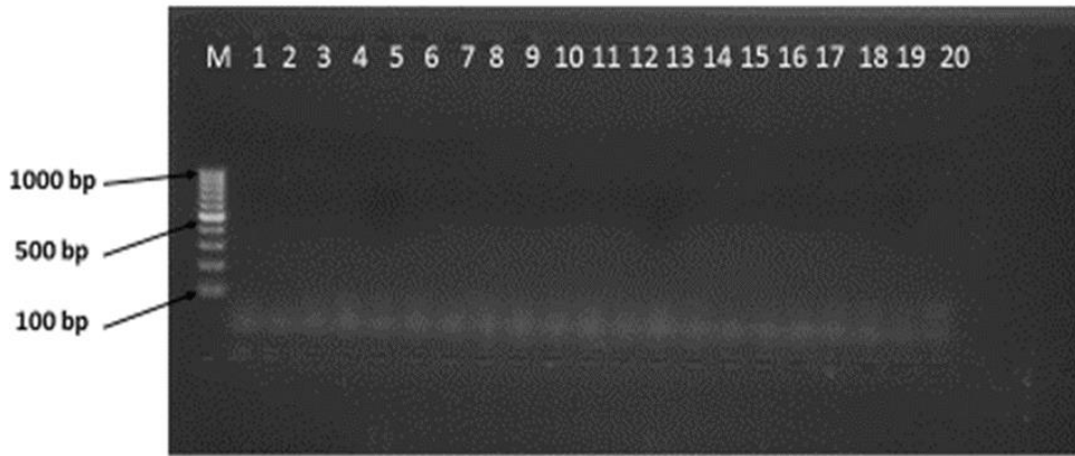
Şekil 4. 7. Avr1 geni için spesifik primer setiyle yapılan Polimeraz Zincir Reaksiyonu ürünlerinin %1.5' luk agaroz jeldeki görüntüsü
