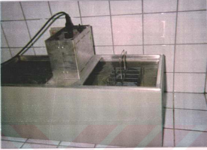
Şekil 3.6. Numuneleri 60 °C Sıcaklığa Getirmek İçin Kullanılan Su Banyosu
