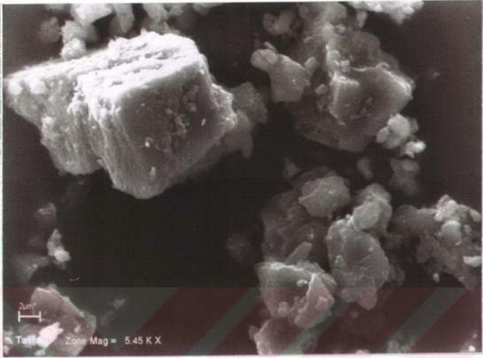
Şekil 4.1. Taş Tozu'nun Elektron Mikroskopunda 5450 Kez Büyültülmüş Hali
