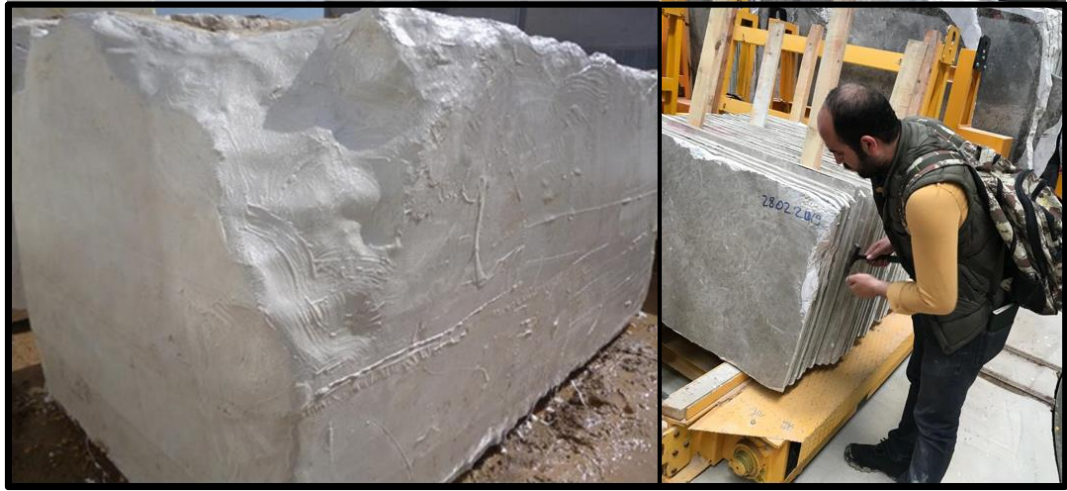
Şekil 3. 14. Mermer bloğun dış yüzeyine uygulanan polyester reçinesinin kuruması ve kesilme sonucu ortaya çıkan mermer levhaları
