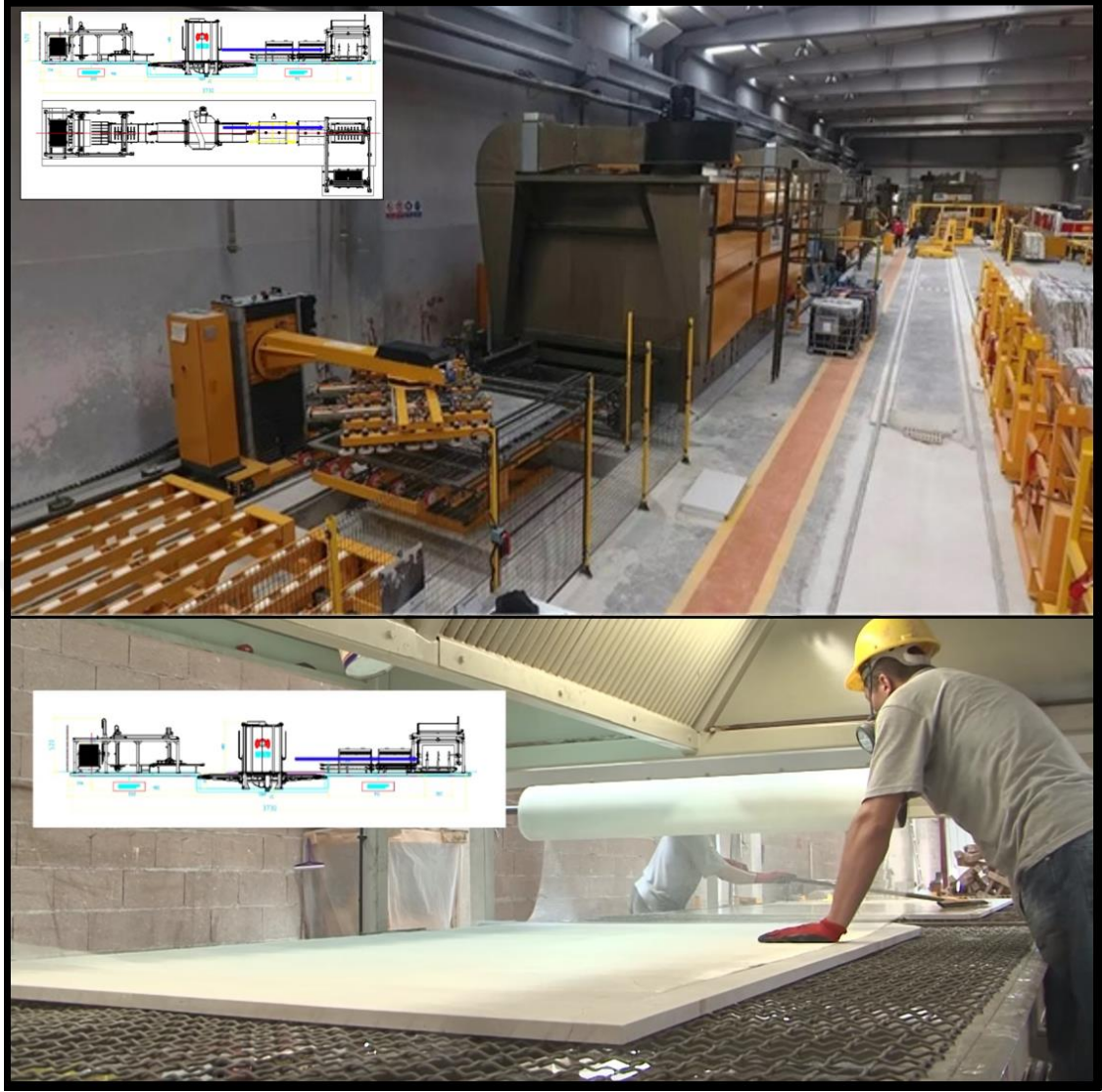
Şekil 3. 10. Mermer levhasına epoksi uygulamadan önce fırınlarda kurutması ve sonra mermer levhasının arka yüzeyine epoksi reçinesi ile fileleme işlemi uygulaması
