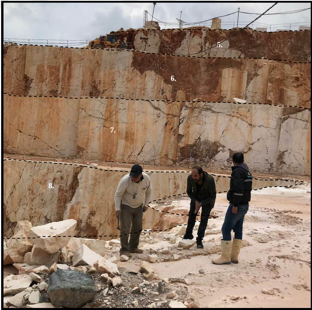
Şekil 3. 4. XRF analizi için örnek alımı ve Limra mermer ocağı arazi çalışması (Rakamlar mermer işletme basamaklarını göstermektedir)
