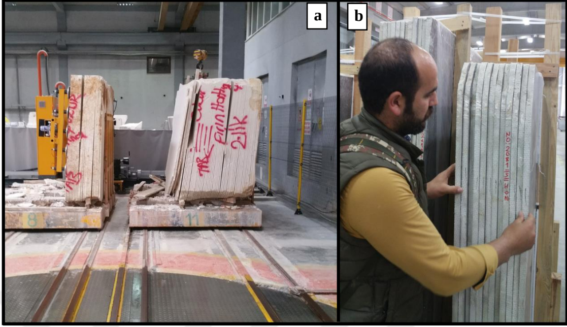
Şekil 3. 15. Mermer bloğun kesiminde oluşan kırılma ve çatlamların sonucunda ortaya çıkan levha kayıpların görünümü; a) Mermer bloğuna polyester reçinesi uygulanmamış hali; b) Mermer bloğuna polyester reçinesi uygulanmış hali
