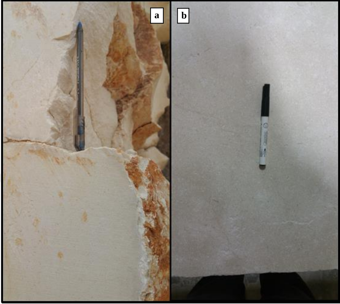
Şekil 2. 1. Beydağları formasyonunda bulunan Limra mermer örneklerinin makroskobik görüntüleri; a) Limra mermerin kesim işlemi görmemiş doğal hali; b) Limra mermerin kesim işlemi görmüş hali
