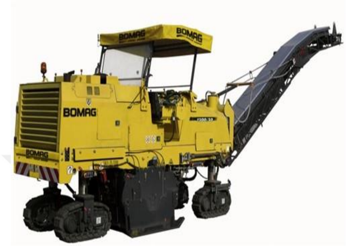
Şekil 2.14. Asfalt Kazıyıcılar - Soğuk Frezeleme Makinası (Cold Milling Machine)
