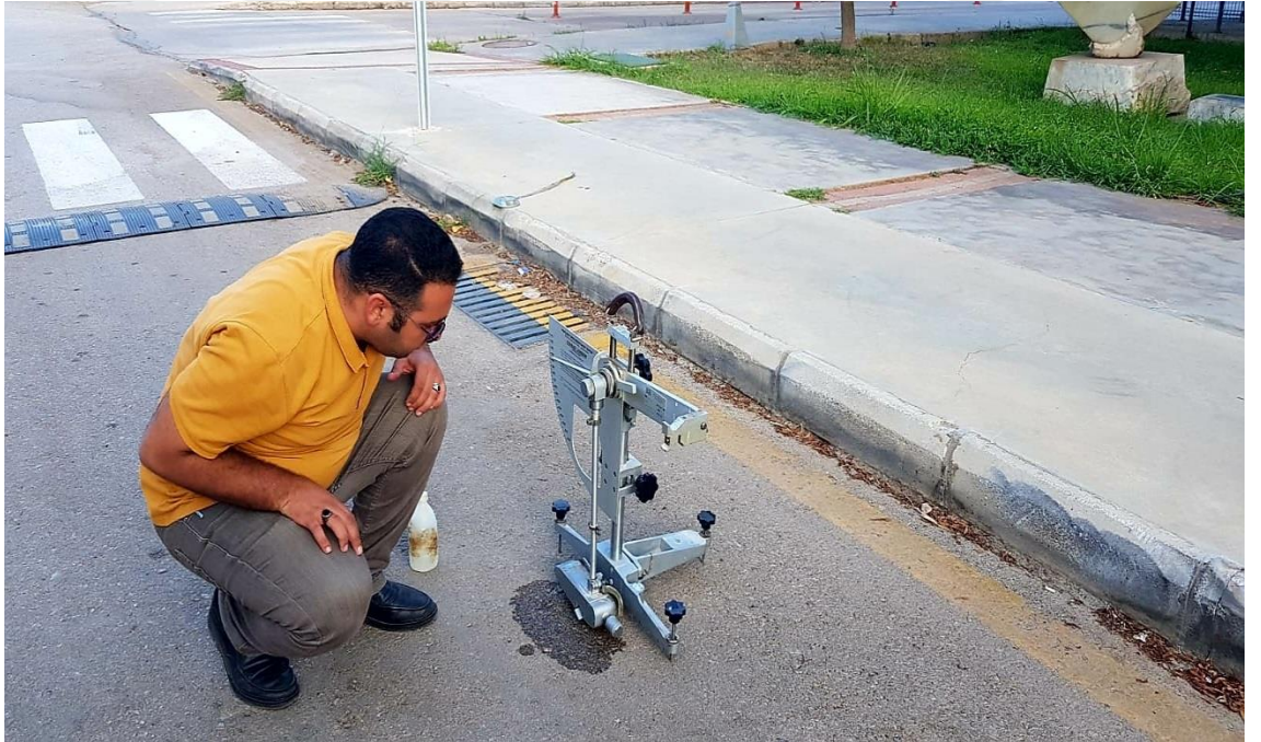
Şekil 3.1. İngiliz Sarkaç Test Cihazını Kullanarak Yüzey Sürtünme Özelliklerinin Ölçülmesi
