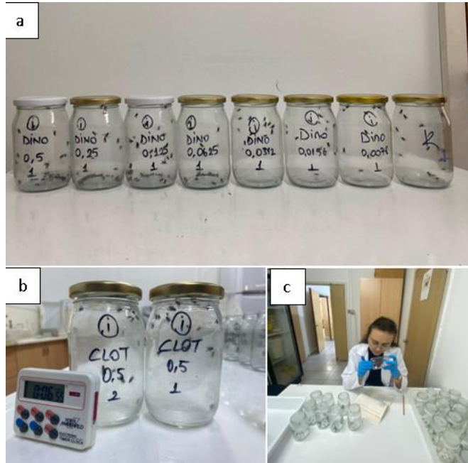
Şekil 3.4. a) Deney düzeneği b) Deney esnasında düşüş (knock down) değerlerinin elde edilmesi c) Deney esnasında ev sineklerinin sayımı
