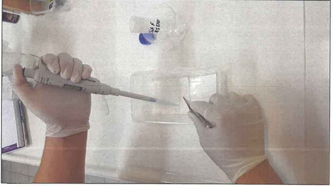
Şekil 3.14. Filtre kâğıtlarına test çözeltilerinin uygulanması
