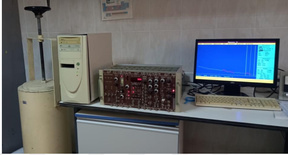
Şekil 3.4. NaI (Tl) dedektörlü gama spektrometre sistemi.
