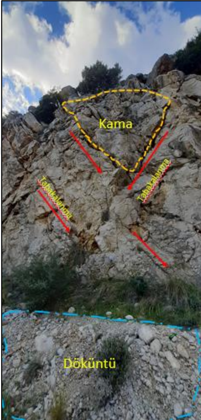
Şekil 4.15. Eklem takımlarının sebep olmuş olduğu yenilme türü görüntüsü
