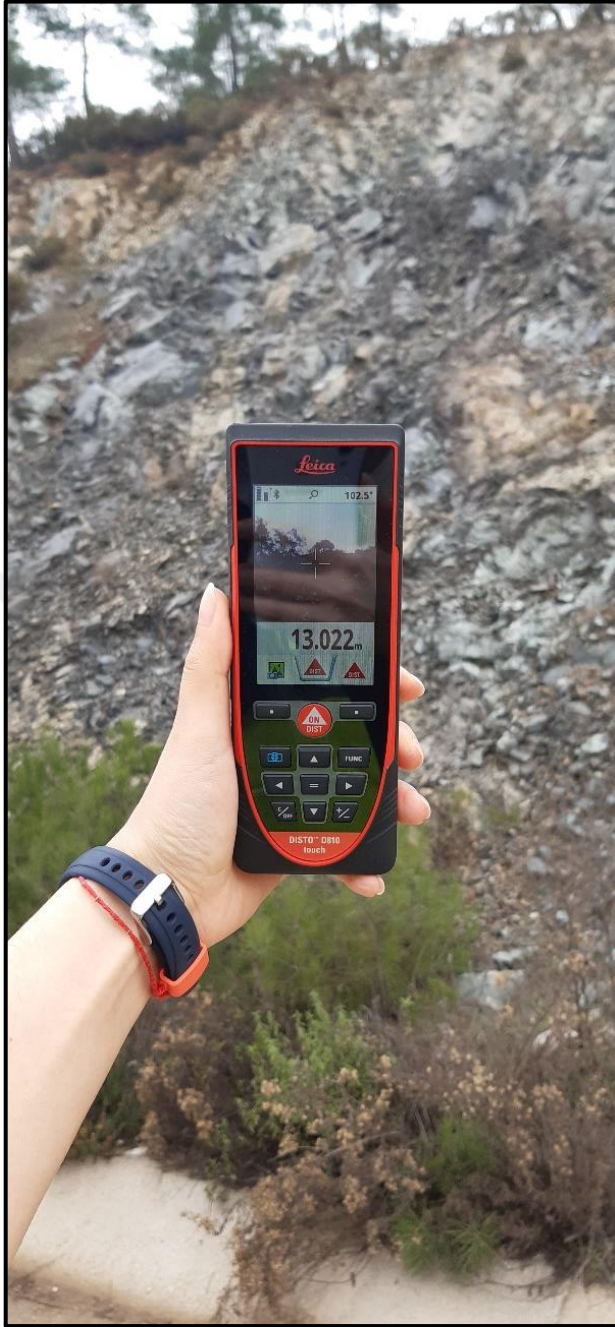
Şekil 3.3. Çalışmada kullanılan DISTO D810 TOUCH marka lazer metre
