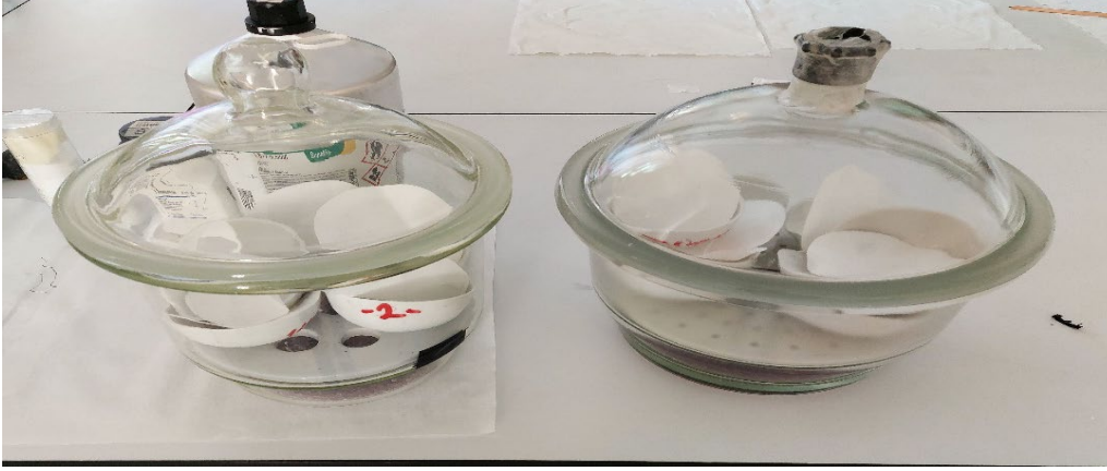
Şekil 3.11. Desikatörde soğutulan filtre kağıtları
