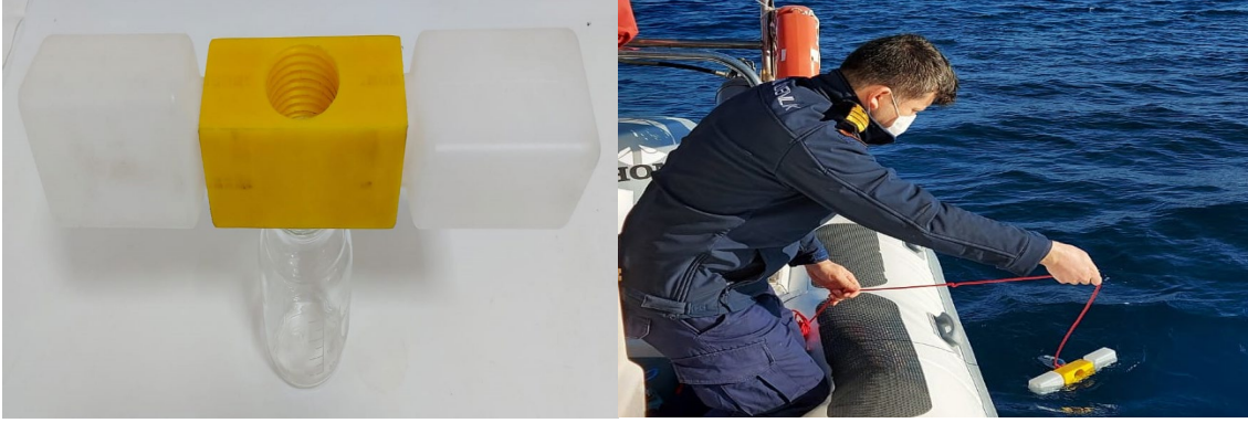
Şekil 3.18. Denizden yağ ve gres numunesi alınmasında modifikasyon yapılarak imal ettirilen aparat
