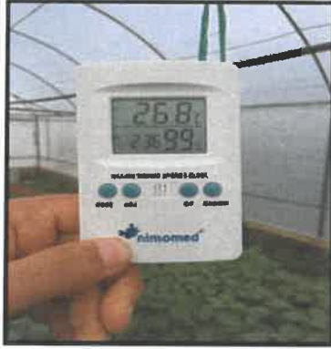
Şekil 3.24. Sera içi sıcaklığının ölçülmesi için kullanılan dijital termometre
