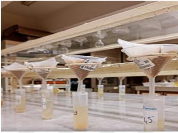
Şekil 3. 5. Toprakta EC- pH analizi için süzüklerin elde edilmesi
