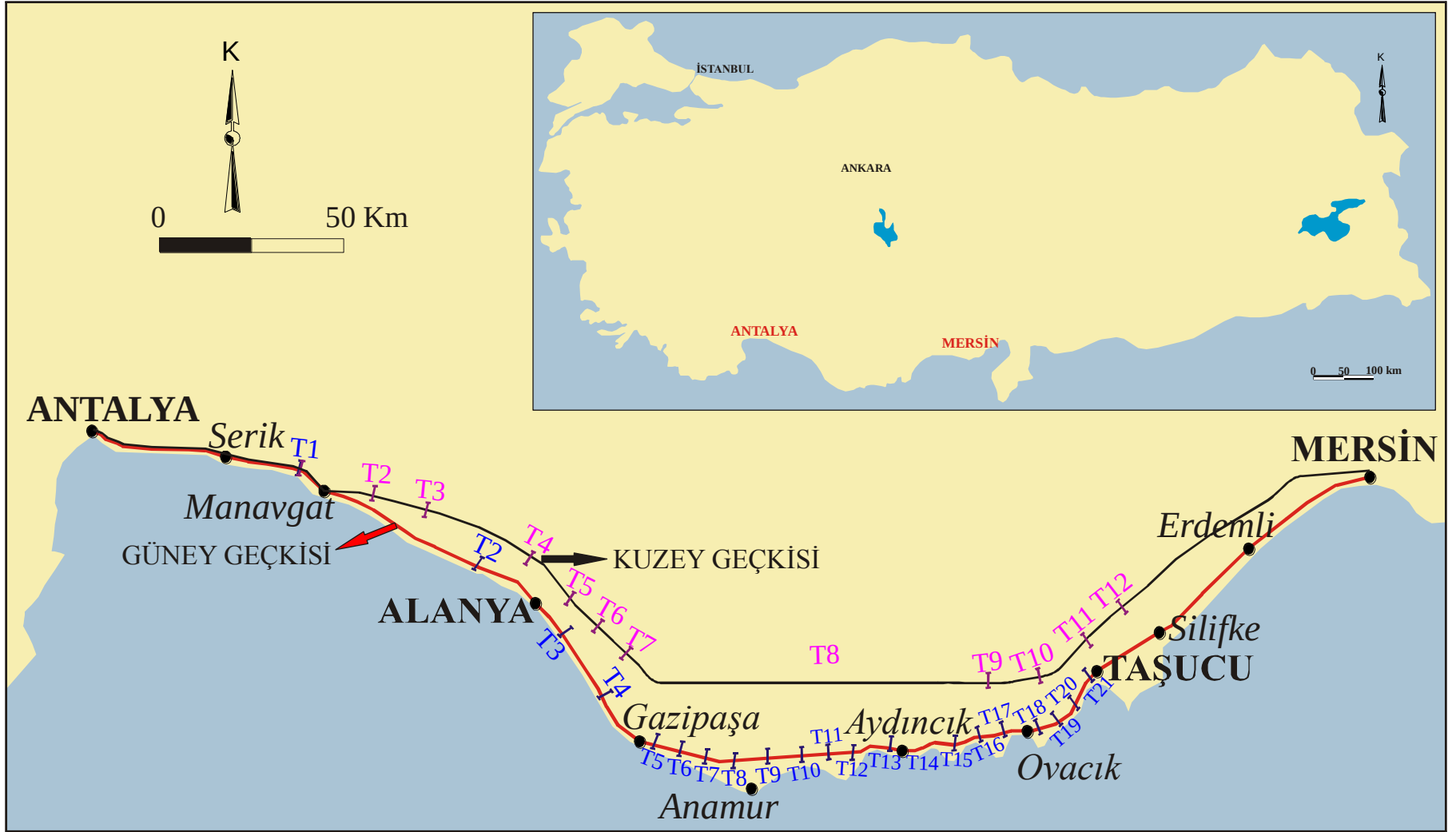
Şekil 4.15. KUZEY ve GÜNEY geçkileri ve tünel yerleri
