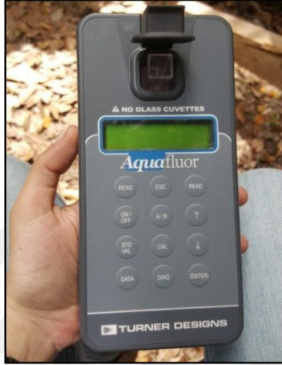
Şekil 5.9. AquaFluor marka el tipi florometre cihazı.
