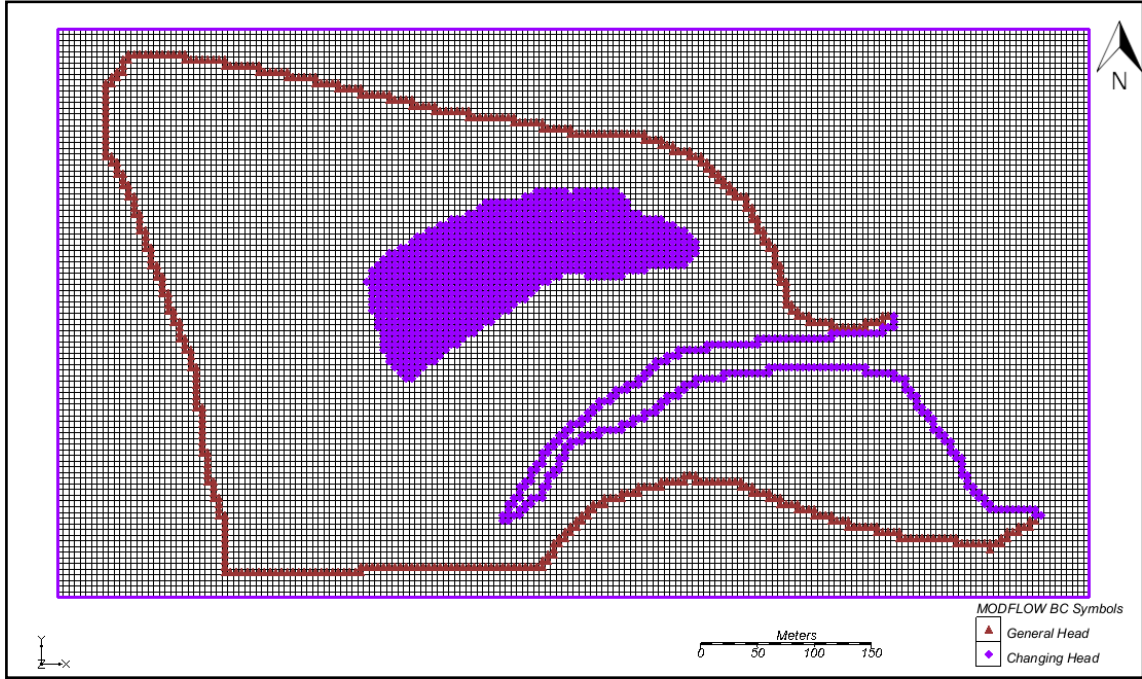
Şekil 6.27. Günümüzden 2000 yıl öncesi için üretilen kavramsal modelin MODFLOW'a aktarılması.
