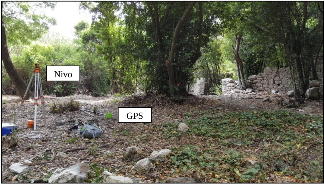
Şekil 5.1. Mozaikli Yapı çevresinde nivo ve şeritmetre kullanılarak yapılan kot ölçümü esnasında alınmış bir görüntü.
