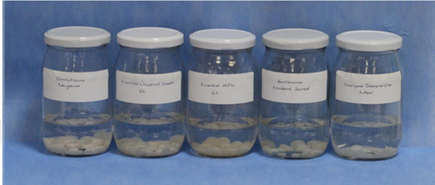
Şekil 3.10. Örneklerin Hazırlandıktan Sonra Distile Suda Bekletilmesi
