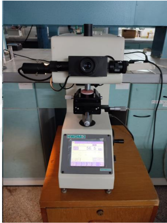
Şekil 3.9. Vickers Sertlik Cihazı
