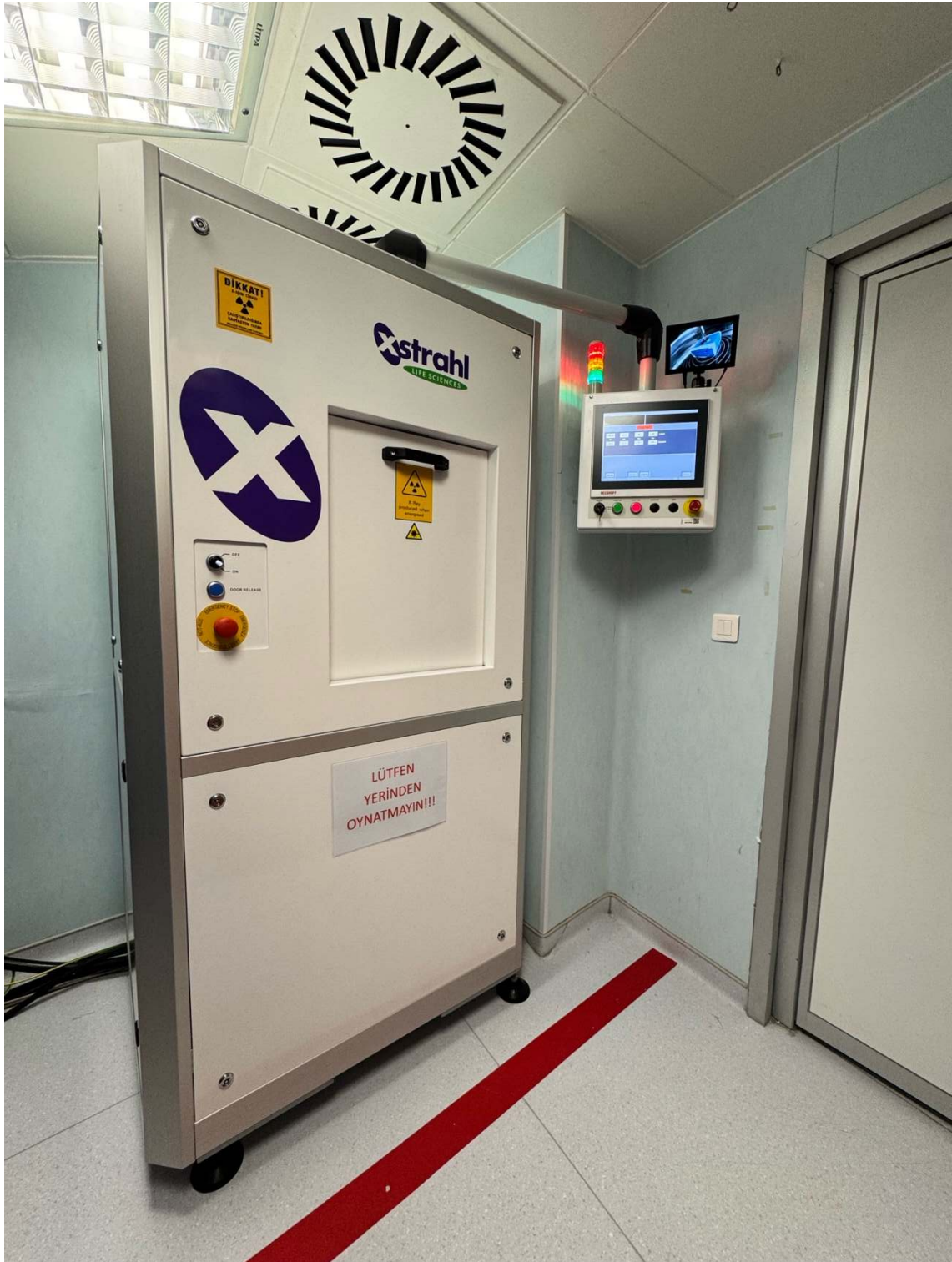
Şekil 3.2 Preklinik araştırmalar için kapalı sistem ışınlama cihazı.
