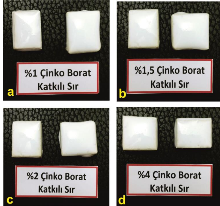
Şekil 4.4.6. a) Sır malzemesine % 1 Çinko Borat eklenerek üretilen seramik b) Sır malzemesine % 1,5 Çinko Borat eklenerek üretilen seramik c) Sır malzemesine % 2 Çinko Borat eklenerek üretilen seramik d) Sır malzemesine % 4 Çinko Borat eklenerek üretilen seramik
