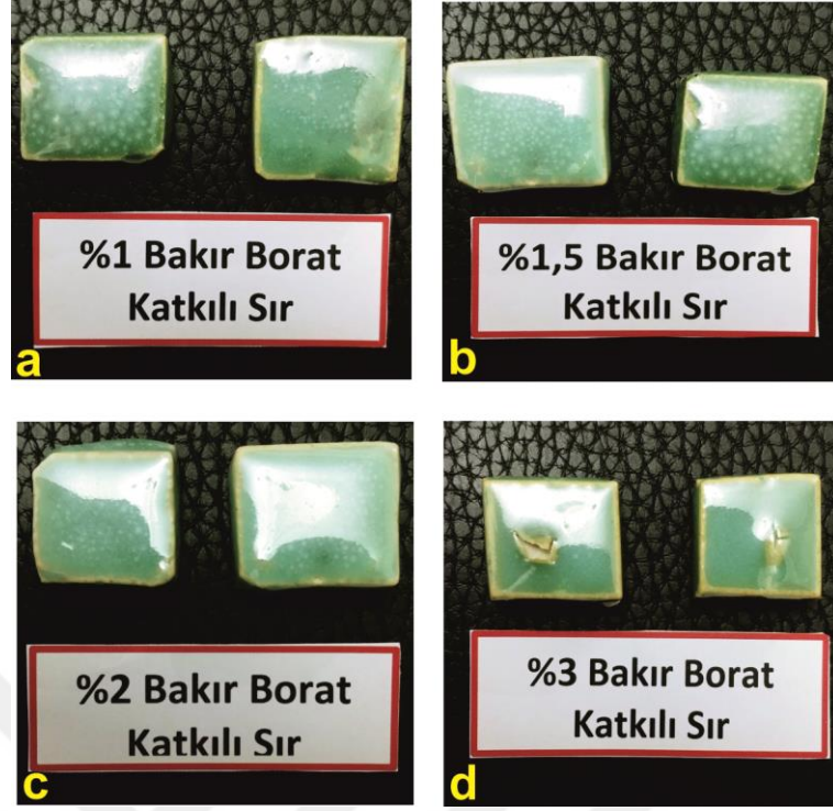
Şekil 4.4.5. a) Sır malzemesine % 1 Bakır Borat eklenerek üretilen seramik b) Sır malzemesine % 1,5 Bakır Borat eklenerek üretilen seramik c) Sır malzemesine % 2 Bakır Borat eklenerek üretilen seramik d) Sır malzemesine % 3 Bakır Borat eklenerek üretilen seramik
