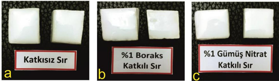
Şekil 4.4.1. a) Ham sır (katkısız) malzemesi ile üretilen seramik b) Sır malzemesine %1 Boraks eklenerek üretilen seramik c) Sır malzemesine % 1 Gümüş Nitrat eklenerek üretilen seramik
