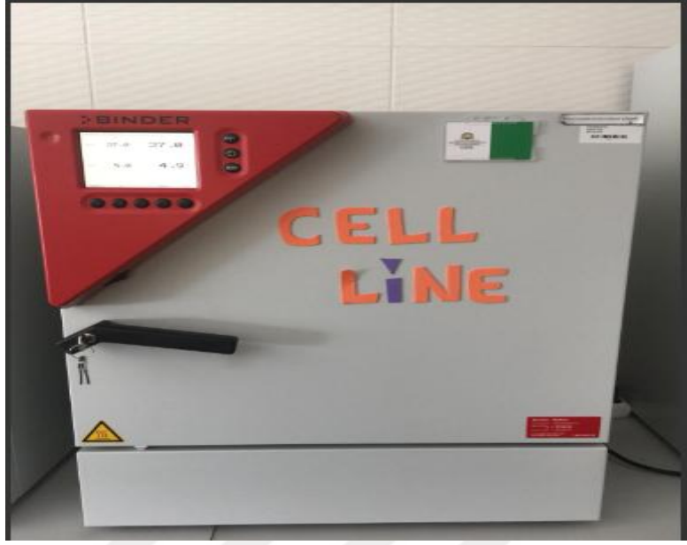
Resim 2: Hücrelerin büyütüldüğü inkübatör
